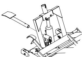
Figura 7: ensamblaje del pedal accionado por el pie.
