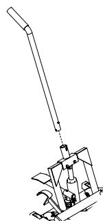
Figura 8: ensamblaje de la manija.
