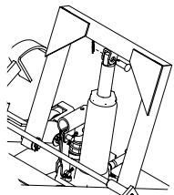
Figure 4: Insertion de la tige du cric-bouteille
