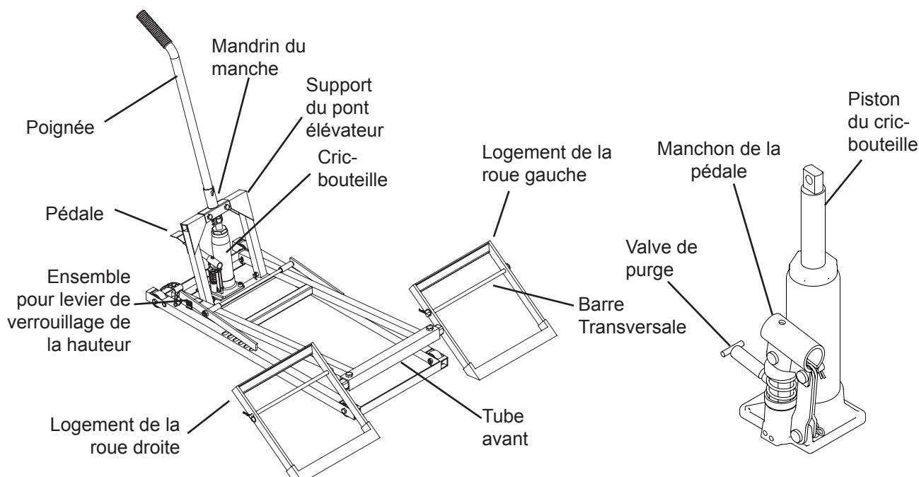
Figure 1 : Nomenclature du pont élévateur à tondeuse
