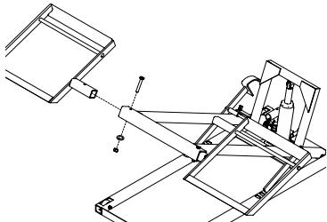
Figure 5: Fixation du support de roue
