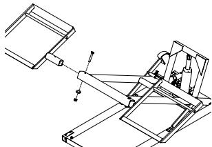
Figura 5: colocación de la abrazadera para ruedas
