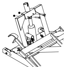
Figura 6: ensamblaje de abrazadera para manipulación.
