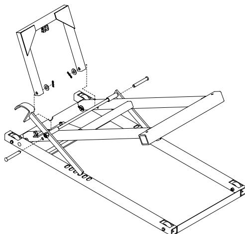
Figura 2: ensamblaje del soporte de levantamiento.
